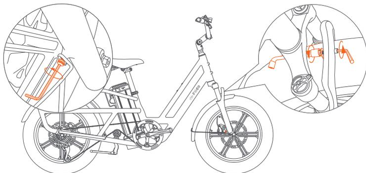
② Serrer les vis des deux côtés de la crosse de l'aile pour terminer l'installation de l'aile.
