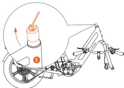
① Retirez la gaine de protection de l'élévateur de fourche : Utilisez l'outil hexagonal pour dévisser la vis de l'élévateur et retirer le manchon de protection.
