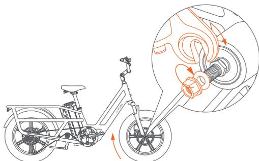
① Puis mettre la fourche sur l'axe de la roue, mettre le collier et serrer l'écrou.
