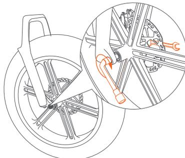
② A l'aide d'une clé à fourche et d'une clé à douille, serrer fermement les écrous des deux côtés.
