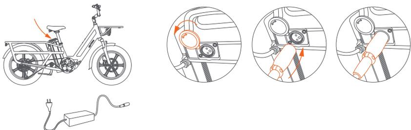
1. Connexion de charge : Connectez l'interface de charge du chargeur au port de charge, puis connectez la fiche d'alimentation du chargeur à la prise de courant.
