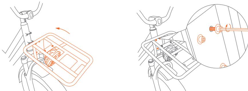
① Alinee los cuatro orificios de la cesta delantera con los cuatro orificios del cabezal de la bicicleta y ajuste los tornillos.
