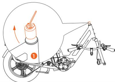
① Retire la funda protectora del elevador de la horquilla: Use la herramienta hexagonal para desatornillar el tornillo del elevador y retire la funda protectora.
