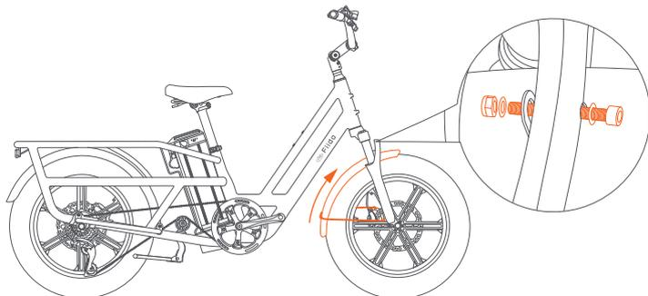
① Coloque el guardabarros delantero a través del espacio entre el neumático y la horquilla, luego atornillelo firmemente.
