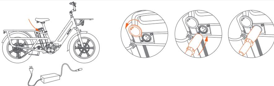
1. Conexión de carga: Conecte la interfaz de carga del cargador al puerto de carga, luego conecte el enchufe de alimentación del cargador a la toma de corriente.
