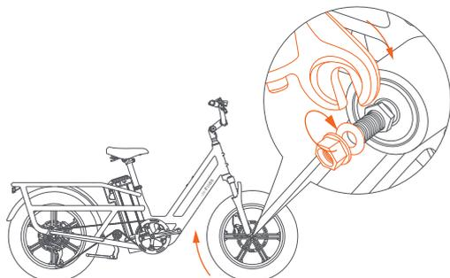
① Luego coloque la horquilla en el eje de la rueda, coloque el collar y apriete la tuerca.
