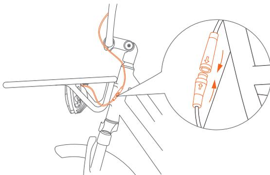
② Inserte el cable de la luz delantera: alinee la luz delantera con el cable de interfaz amarillo reservado para el cabezal de la bicicleta, siguiendo la dirección de la flecha en la interfaz. Inserte la interfaz para completar la instalación de la luz delantera para la cesta de la bicicleta.
