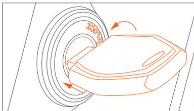
① Presione y coloque la llave en la posición "UNLOCK"
