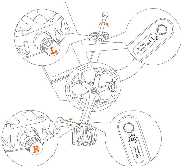
Utilice la llave de boca de la bolsa de herramientas, enrosque el eje del pedal en el orificio roscado y apriételo en la dirección de la flecha.
