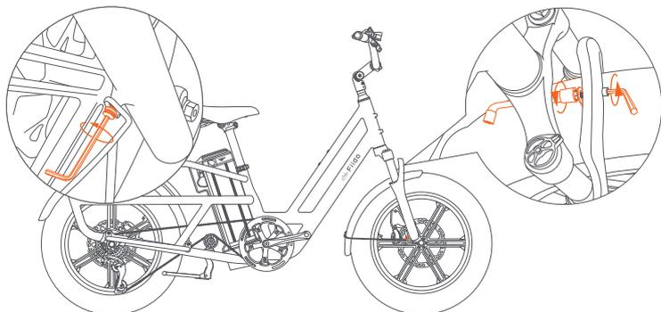
② Apriete los tornillos en ambos lados del guardabarros para completar la instalación del guardabarros.
