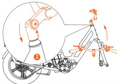
② Instalar el vástago: Alinee el vástago con el tubo de dirección y.
