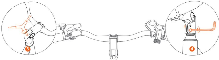
③ Bloquee el vástago: Use la herramienta hexagonal para bloquear los tornillos del vástago firmemente para evitar que se aflojen.
