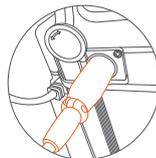
1. Anschluss zum Aufladen: Verbinden Sie die Ladeschnittstelle des Ladegeräts mit dem Ladeanschluss, dann verbinden Sie den Netzstecker des Ladegeräts mit der Steckdose.
