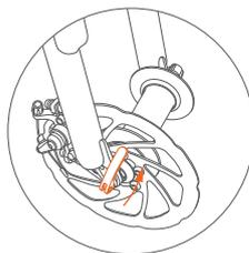
③ Inserire l'asse anteriore attraverso la ruota anteriore e caricare la molla, avvitare il dado, bloccare lo smontaggio rapido della ruota anteriore.
