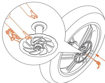
② Sollevare la parte anteriore della bici, allineare la ruota anteriore e inserire l'anello del fodero della forcella anteriore.
