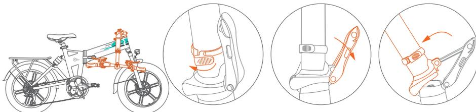
Aprire il gancio di sicurezza dello stelo, ruotare il morsetto dello stelo verso il basso per mantenerlo aperto. Ruotare delicatamente lo stelo verso il basso fino in fondo, per completare la piegatura dello stelo.
