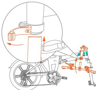
① Sollevare il tubo verticale verso l'alto, come mostrato nello schema, per formare un angolo con la bici elettrica e inserirlo nel manubrio.
