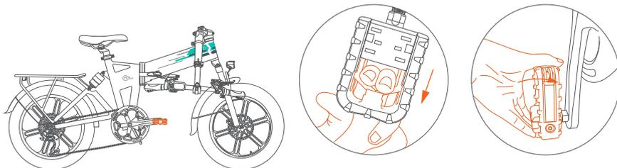
Premere il pedale nella direzione della freccia per piegarlo e riportarlo più facilmente.
