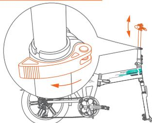
④ Regolare il montante all'altezza adatta e chiudere il morsetto del montante.
