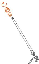
① Schrauben Sie die Mutter und die Feder des Vorderrad-Schnellspanners ab.
