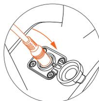
1. Conexión de carga: Conecte la interfaz de carga del cargador al puerto de carga, luego conecte el enchufe de alimentación del cargador a la toma de corriente.
