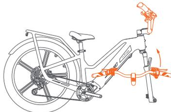
② Instale el manubrio: coloque el manubrio en la posición delantera, tenga en cuenta que el freno debe ir hacia adelante.
