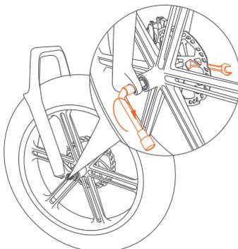
① Luego, coloque la horquilla en el eje de la rueda, coloque el collar y apriete la tuerca.
