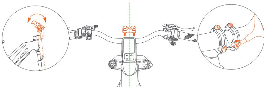
③ Ajuste el manubrio a la posición correcta, debe estar en paralelo con la horquilla; cierre la abrazadera del manubrio y apriete el tornillo.
