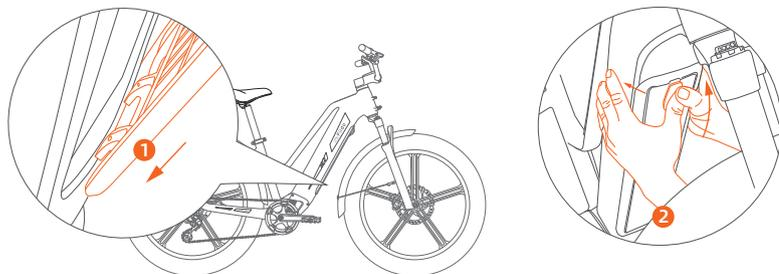
① Inserte primero el extremo inferior de la tapa de la batería en el extremo inferior del cuadro.
