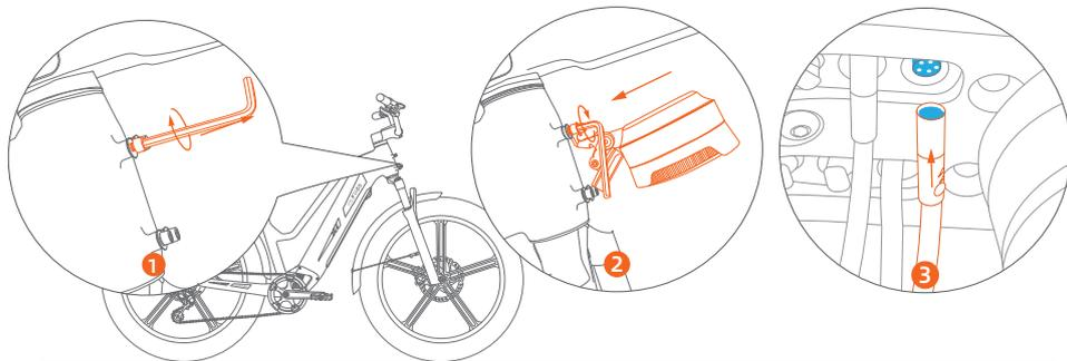
① Retire el tornillo y el espaciador montados en el extremo superior del tubo de dirección.
