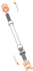
① Retirer d'abord l'écrou et le collier de roue.
