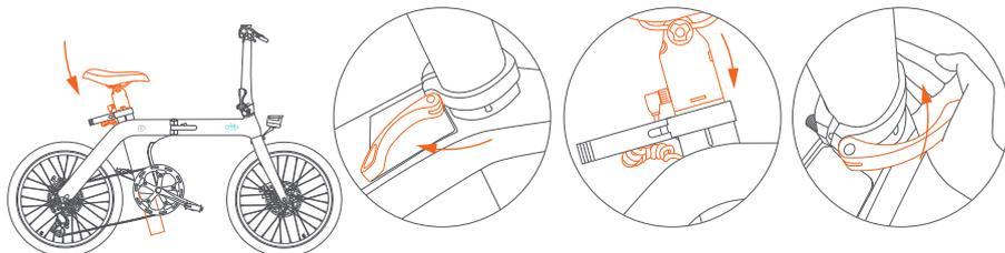
Soulevez le collier de serrage de la selle pour le maintenir en position ouverte. Appuyez doucement sur la tige de selle jusqu'au fond. Appuyez sur le collier de serrage pour le maintenir en position fermée.
