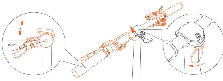
③ Ajuster la direction du guidon, pour qu'il fasse un angle de 15°-20° avec la ligne horizontale, puis fermer le blocage rapide, pour terminer le dépliage de la tige.
