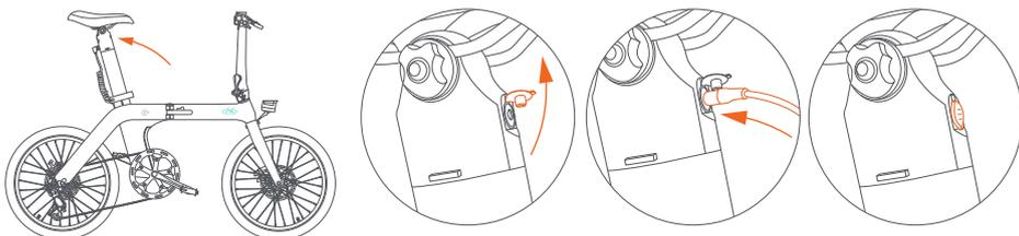
1. Connexion de charge : Connectez l'interface de charge du chargeur au port de charge, puis connectez la fiche d'alimentation du chargeur à la prise de courant.
