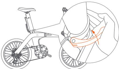
③ Bouclez le collier de serrage de la selle pour vous assurer que la tige de selle ne glisse pas vers le bas. (Attention : Si le collier de siège est relativement lâche, veuillez ouvrir le collier de siège et serrer les écrous, afin d'assurer que la batterie de la tige de selle ne se desserre pas pendant la conduite)
