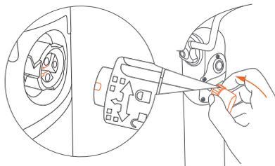
④ Insérez le fil d'alimentation de la batterie dans le connecteur d'alimentation de la batterie pour terminer l'installation de la batterie de la tige de selle.
