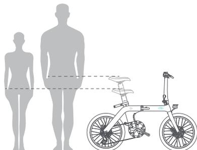
② Régler la batterie de la tige de selle à la hauteur appropriée, la hauteur recommandée est celle où la selle est au niveau du bassin de l'utilisateur lorsqu'il se tient debout naturellement. (La hauteur minimale de la selle ne peut pas dépasser la limite du tube de selle de la batterie, et la hauteur maximale ne peut pas dépasser la ligne MIN de l'échelle de sécurité de la batterie de la tige de selle.)
