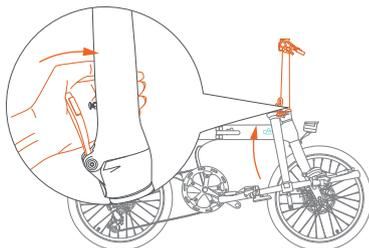
① Ouvrir le blocage rapide, ajuster la direction du guidon vers le haut pour détacher le câble.
