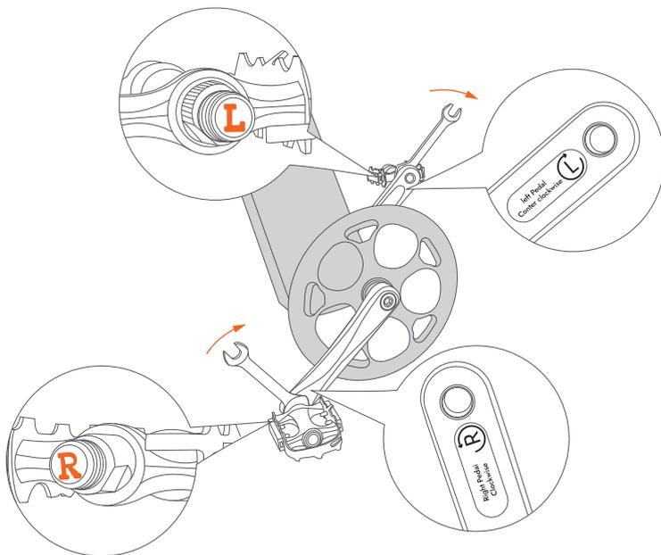
Utilisez la clé ouverte du sac d'outils, vissez l'axe de la pédale dans le trou fileté et serrez-le dans le sens de la flèche.
