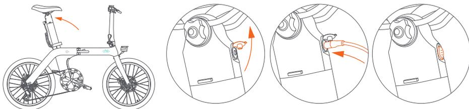
1. Collegamento di ricarica: collegare l'interfaccia di ricarica del caricabatterie alla porta di ricarica, poi collegare la spina di alimentazione del caricabatterie alla presa di corrente.
