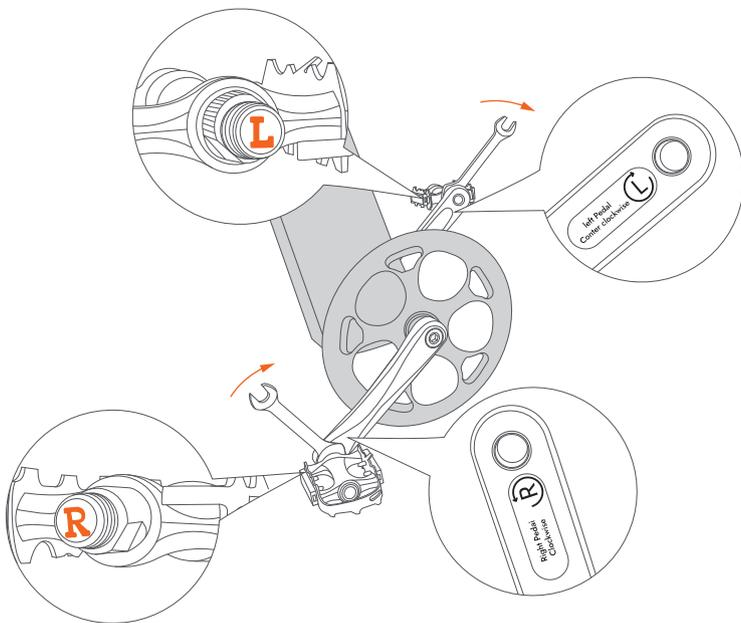
Utilizzare la chiave inglese aperta della borsa degli attrezzi, avvitare l'asse del pedale nel foro filettato e stringere nella direzione della freccia.
