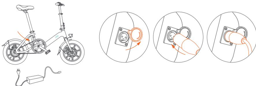
1. Conexión de carga: Conecte la interfaz de carga del cargador al puerto de carga, luego conecte el enchufe de alimentación del cargador a la toma de corriente.
