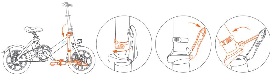
Abra el gancho de seguridad del vástago, gire la abrazadera del vástago hacia abajo para mantenerla en estado abierto. Gire suavemente el vástago hacia abajo hasta el fondo para terminar de plegar el vástago.
