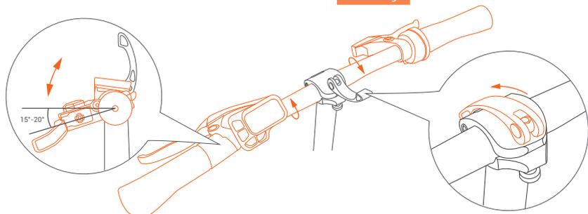
③ Ajuste la dirección del manubrio para que quede en un ángulo de 15°-20° con la línea horizontal, luego cierre el cierre rápido, para completar el despliegue del vástago.
