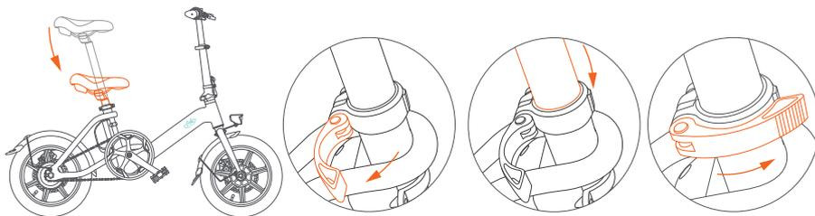
Levante la abrazadera del Asiento hacia arriba para mantenerla en estado abierto. Presione suavemente la tija del Asiento hacia abajo. Presione hacia abajo la abrazadera del Asiento para mantenerla en estado cerrado.
