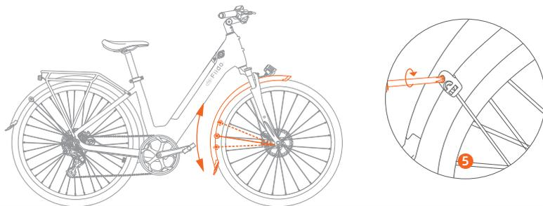
⑤ Ajuste el ángulo de la posición del soporte del guardabarros para mantenerlo a una cierta distancia del neumático, luego use los tornillos autorrosantes para bloquear los soportes.
