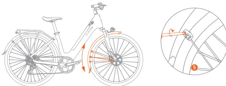
⑤ Stellen Sie den Winkel des Schutzblechständers so ein, dass das Schutzblech einen bestimmten Abstand zum Reifen hat, und verwenden Sie dann die Klemmschrauben, um die Ständer zu fixieren.
