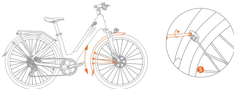
⑤ Ajustez l'angle de la position des béquilles de garde-boue pour maintenir le garde-boue à une certaine distance du pneu, puis utilisez les vis autotaraudeuses pour verrouiller les béquilles de garde-boue.
