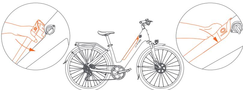
② Installez la batterie : placez la partie inférieure de la batterie dans la fente, puis appuyez dessus. La batterie sera verrouillée dans le cadre.
