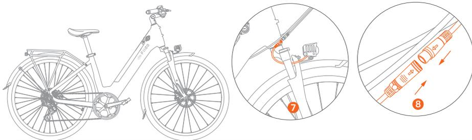
⑦ Pase el cable del faro a través del centro del tenedor hacia la parte trasera del tenedor.
