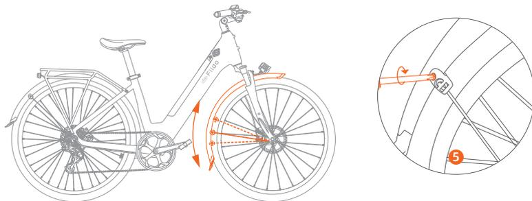
⑤ Ajuste el ángulo de la posición del soporte del guardabarros para mantener el guardabarros a una cierta distancia del neumático, luego utilice los tornillos autorroscantes para bloquear los soportes.
