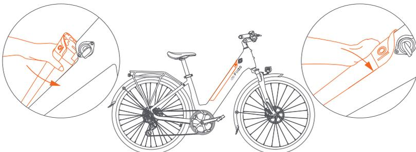
② Instalar la batería: Coloque la parte inferior de la batería en la ranura y luego presione hacia abajo. La batería quedará bloqueada en el marco.
