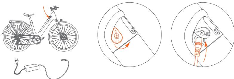
1. Conexión de carga: Conecte la interfaz de carga del cargador al puerto de carga, luego conecte el enchufe del cargador a la toma de corriente.
