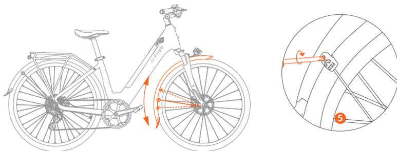
⑤ Ajustez l'angle de la position de la béquille de garde-boue pour maintenir le garde-boue à une certaine distance du pneu, puis utilisez les vis autotaraudeuses pour verrouiller les béquilles de garde-boue.
