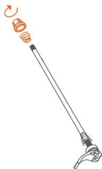
① Dévisser l'écrou et le ressort du blocage rapide de la roue avant.
