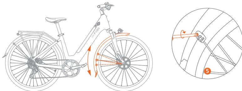
⑤ Regolare l'angolazione della posizione del supporto del parafango per mantenere il parafango a una certa distanza dal pneumatico, quindi utilizzare le viti autofilettanti per bloccare i supporti.
