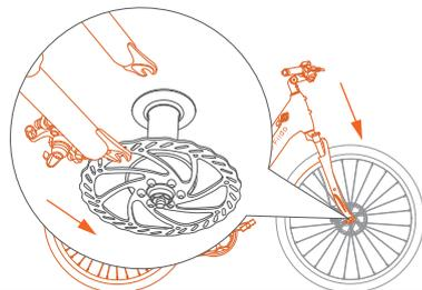
② Sollevare la parte anteriore della bici, allineare la ruota anteriore e inserire l'anello del fodero della forcella anteriore.
