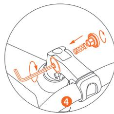
④ Bloccare le viti di contro-bloccaggio e utilizzare uno strumento per viti a brugola per bloccarle in modo sicuro.
