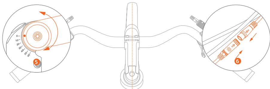
⑤ Regola l'angolo di inclinazione del manubrio, l'angolo predefinito è 0°; puoi regolarlo in base alle tue abitudini di guida; (Controlla se la direzione del manubrio e della ruota anteriore possono essere allineate, in caso contrario, puoi allentare le 2 viti sul lato del manubrio per regolarlo.)
