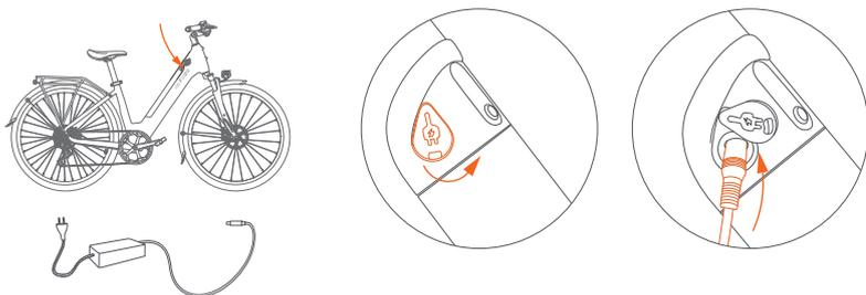
1. Collegamento di ricarica: collegare l'interfaccia di ricarica del caricabatterie alla porta di ricarica, poi collegare la spina di alimentazione del caricabatterie alla presa di corrente.
