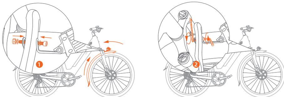
① Far passare il parafango anteriore attraverso la parte posteriore della forcella anteriore, e posizionare il faretto nella parte anteriore della forcella anteriore e far passare le viti (la direzione del faretto è come mostrato nella Fig. )
