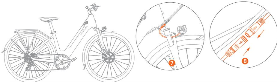
⑦ Posizionare il cavo del faro attraverso il centro della forcella fino alla parte posteriore della forcella.
